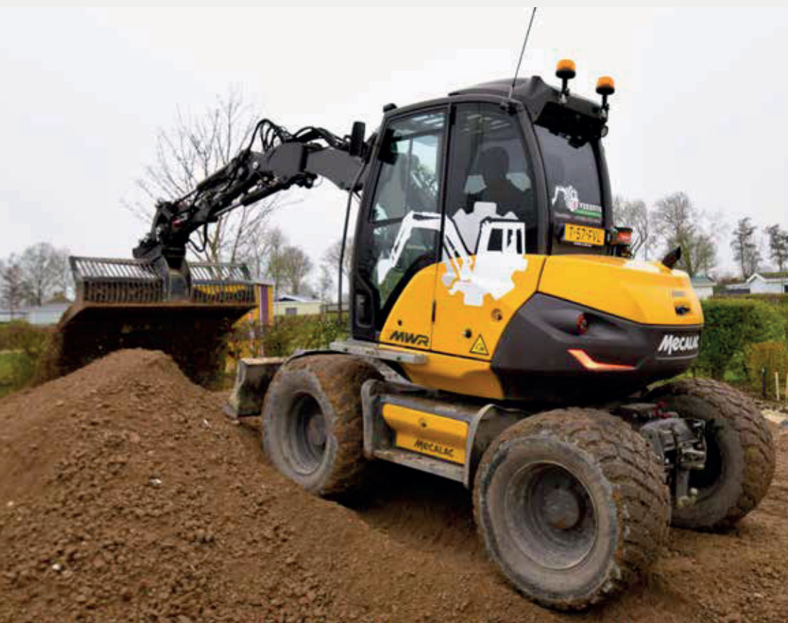
De 3-delige Mecalac-giek is een pareltje. De lepelcilinder en hydrostatische aandrijving zorgen voor genoeg duwkracht om al rijdend materiaal te verplaatsen of een baan te schuiven.
