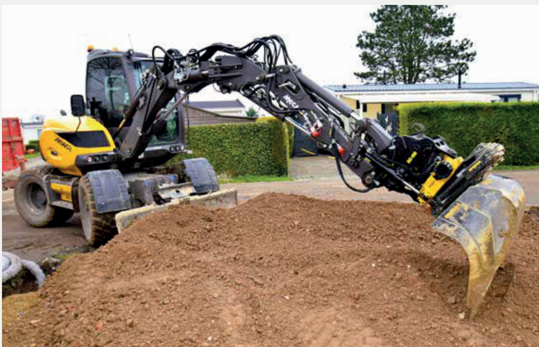
De 7MWR zit vol opties, zoals een trekhaakset met kipperfunctie, lastcompensator, automatische vetsmering op boven- en onderwagen, treeplank, LED-werklampen, extra camera met apart scherm, brandstofpomp en engcon EC209 draaikantelstuk met DC2-besturing.
