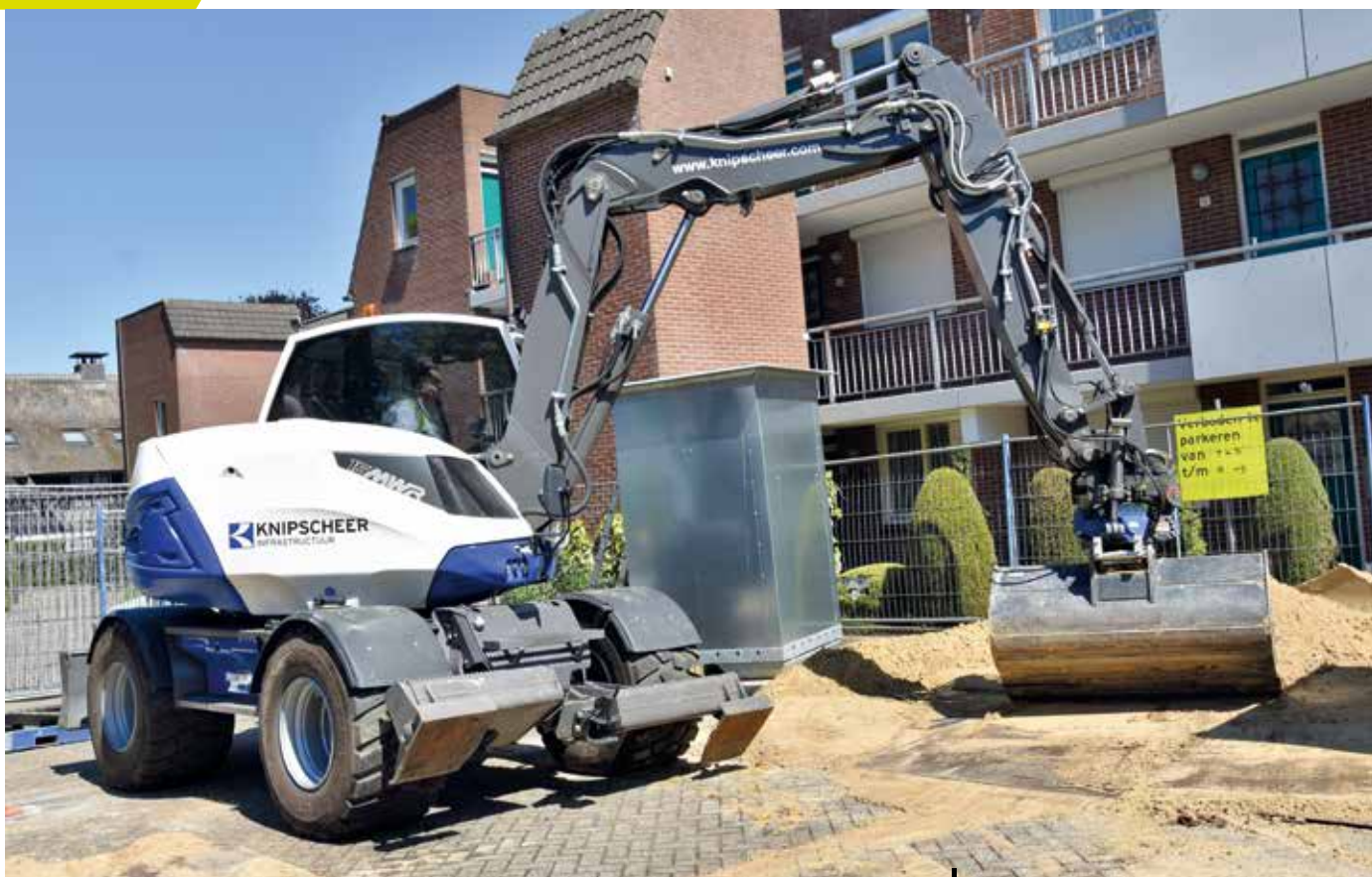
Omwille van het zware hijswerk is gekozen voor een onderwagen met schuifblad en twee onafhankelijk bedienbare stempelpoten.
