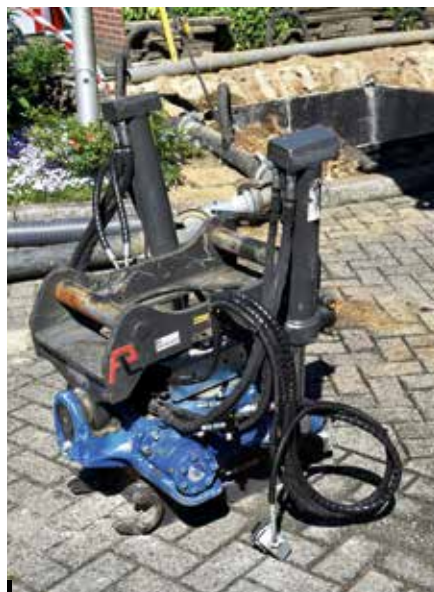
Het wegnemen van het draaikantelstuk vraagt weinig tijd en scheelt toch 420 kg.
