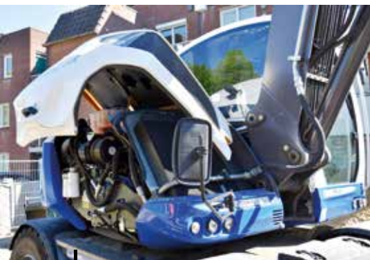
De filters en motor zijn voor dagelijks onderhoud zeer goed en veilig toegankelijk.
