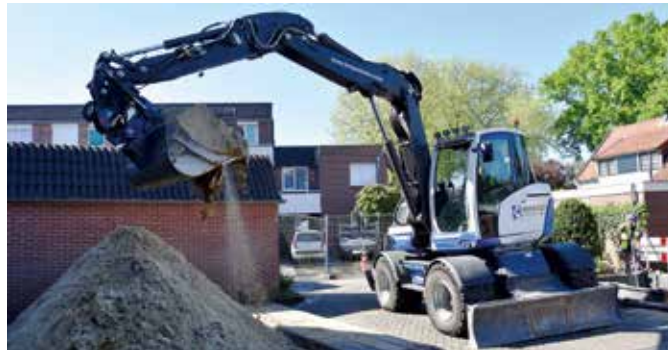
De 15-tons bandenkraan is zeer wendbaar en heeft een groot werkbereik.
