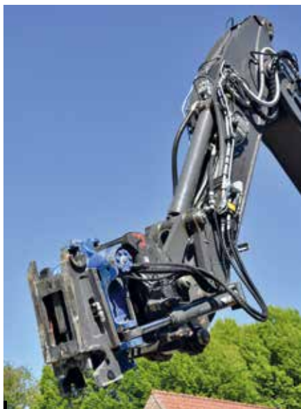
Pladdet leverde een afneembare SMP ST15 TXS tiltrotator met S60 snelwissel.
