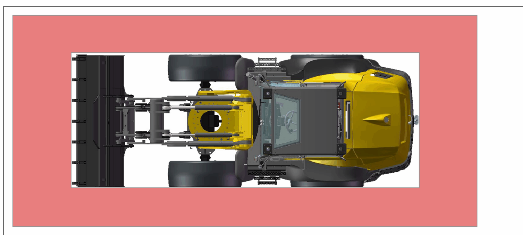
Gevarenczones om de wiellader
